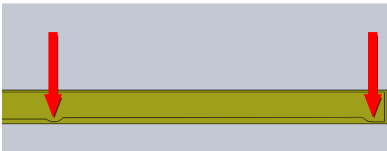
Le sedi per le ruote ricavate sulla guida permettono di mantenere il cestello in posizione rialzata
